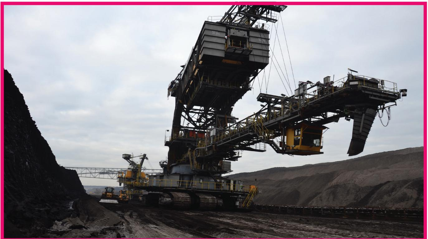
Monstrum von Maschine – die Schaufelradbagger im Tagebau Welzow haben eine Nennförderleistung von bis zu 3 500 m<sup>3</sup>/h im Kohleabbau
