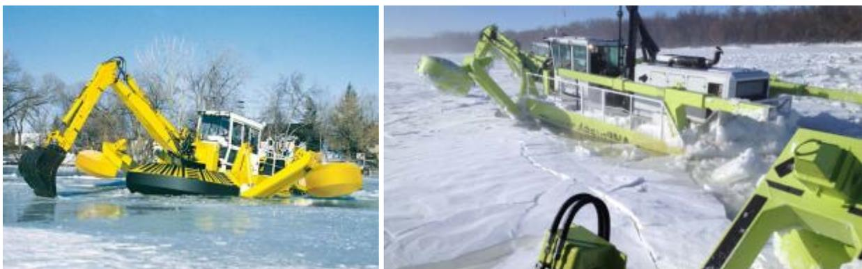
Abbildung 50: AMPHIBEX AE450E als Eisbrecher (<http://www.normrock.ca/> und <https://i.cbc.ca>)
