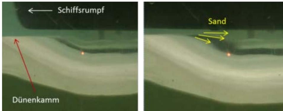
Abbildung 56: Geschwindigkeitsverteilung unter dem Bootsrumpf und resultierende Erosion bei Passage eines Dünenkamms und Bergfahrt (aus Robijns, 2014)
