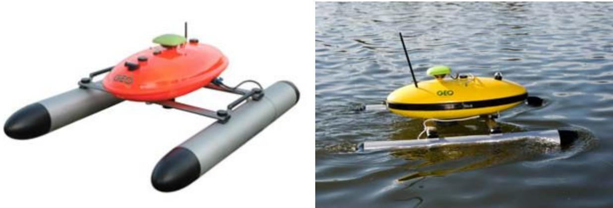
Abbildung 57: Beispiel eines autonomen GPS-Echolot-Messboots („Sonobot“ <http://www.geo-dv.de>)
